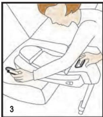
Для того чтобы выдвинуть коннекторы Isofix, приведите в действие рукоятку, расположенную в середине передней части RECAROfix, и вытяните коннекторы до упора.
