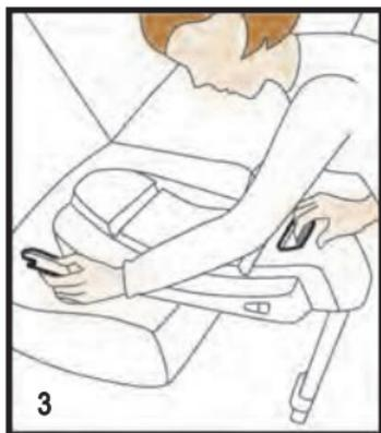
Pour sortir les connecteurs Isofix, actionnez la poignée au centre de la RECAROfix, à l'avant, et sortez les connecteurs jusqu'à la butée.
