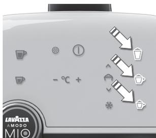
**5. Drücken Sie die Taste für einen kleinen Cappuccino, um die Einstellung „Hohe Wasserhärte“ (Standardeinstellung) auszuwählen, die Taste für einen großen Cappuccino, um die Einstellung „Mittlere Wasserhärte“ auszuwählen oder die Taste für einen Milchkaffee, um die Einstellung „Niedrige Wasserhärte“ auszuwählen. Daraufhin fängt die ausgewählte Taste an zu blinken.**
