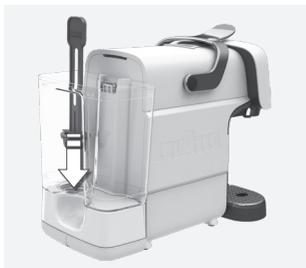
**7. Filtro dell'acqua.** La macchina è dotata di un filtro opzionale pre-confezionato che porta la durezza dell'acqua del proprio rubinetto al livello ottimale e aiuta a prolungare la durata della macchina. Rimuovere l'imballaggio in plastica dal filtro. Inserire il filtro in un contenitore con acqua fresca pulita e lasciarlo in immersione per 10 minuti. Posizionare il filtro nella sua sede sul fondo del serbatoio dell'acqua.
