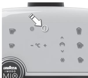
**6. Al termine, premere il pulsante di accensione/spegnimento per tornare alla modalità di stand-by. Quando si seleziona nuovamente la modalità di immissione della durezza, la macchina indicherà le ultime impostazioni.**
