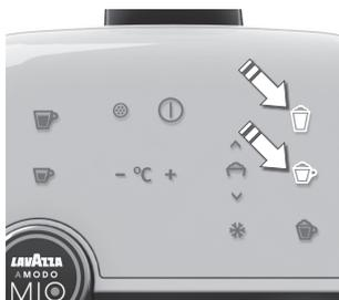
**4. È possibile impostare la macchina in base alla durezza dell'acqua del rubinetto.** Per accedere alla modalità di modifica della durezza dell'acqua, tenere premuti i pulsanti Cappuccino e Latte contemporaneamente per più di 3 secondi. Il pulsante Cappuccino Italiano lampeggia velocemente per indicare che è stata selezionata la "durezza alta" (impostazione predefinita).
