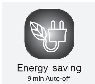
**3. La macchina è dotata di funzione risparmio energetico** che automaticamente spegne l'apparecchio dopo 9 minuti di inutilizzo. È possibile impostare lo spegnimento automatico dopo 30 minuti premendo contemporaneamente i pulsanti Cappuccino e Cappuccino Lungo per più di 3 secondi; successivamente, quando il tasto Cappuccino Corto inizia a lampeggiare velocemente, premere il tasto Cappuccino Lungo.
