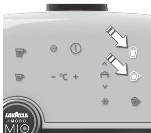
**4. Sie können die Einstellungen der Kaffeemaschine an die Wasserhärte Ihres Leitungswassers anpassen.** Drücken Sie gleichzeitig die Taste für einen großen Cappuccino und die Taste für einen Milchkaffee, und halten Sie dann beide Tasten für mehr als 3 Sekunden lang gedrückt, um in den Bearbeitungsmodus für die Wasserhärte zu wechseln. Die Taste für einen kleinen Cappuccino blinkt daraufhin schnell, um anzuzeigen, dass die Einstellung „Hohe Wasserhärte“ ausgewählt ist (Standardeinstellung).
