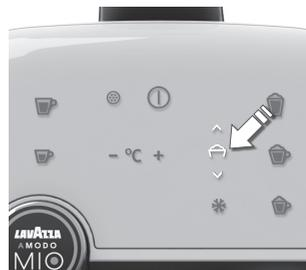
**6. Schaumstufe ändern:** Drücken Sie die Taste für das Einstellen der Milchaufschäumung, um die gewünschte Schaummenge einzustellen. Der Pfeil nach oben zeigt an, dass mehr Schaum ausgewählt wurde. Der Pfeil nach unten zeigt an, dass weniger Schaum ausgewählt wurde.
