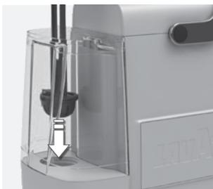
**5.** Filtro dell'acqua. È possibile acquistare un filtro dell'acqua opzionale che porta la durezza dell'acqua del proprio rubinetto al livello ottimale e aiuta a prolungare la durata della macchina. Rimuovere il filtro dall'imballaggio in plastica e posizionarlo nella sua sede, sul fondo del serbatoio dell'acqua. Codice di riferimento del filtro: EPAB 3, EPAB 6
