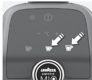
3. **Sie können die Einstellungen der Kaffeemaschine an die Wasserhärte Ihres Leitungswassers anpassen.** Halten Sie die Espresso-Lungo-Taste und die Caffè-Crema-Taste gleichzeitig mehr als 2 Sekunden lang gedrückt, um in den Bearbeitungsmodus für die Wasserhärte zu wechseln. Die Espresso-Lungo-Taste blinkt daraufhin schnell, um anzuzeigen, dass die Einstellung „Mittlere Wasserhärte“ ausgewählt ist (Standardeinstellung).
