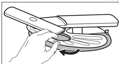
4. Reinigen Sie die Filter.
